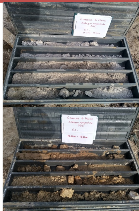
Cassetta catalogatrice delle carote estratte
